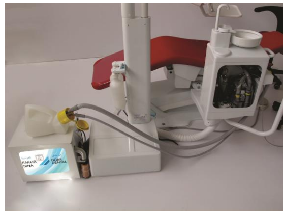
شکل ۷: شستشو و گندزدایی مسیر سر ساکشن ها
